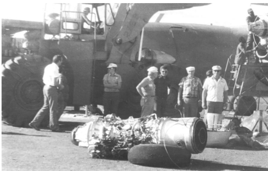
Пос. Джамба на юге Анголы. Замена двигателя на самолете АН-26 после аварийной посадки Апрель 1982 г.
